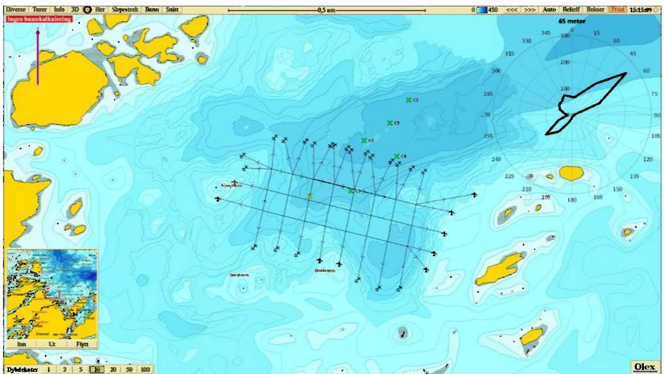
Figur 6: Kartet viser anleggs plassering sammen med C-stasjoner og fortøyningslinjer. Lilla pil viser orientering av kart, strømrøse viser vanntransport ( m^3/m^2/døgn ) for hver 15° sektor på 65 meters dyp (spredningsdyp), gult kryss markerer posisjon for strømmålingene i 2015 (64°57.228N, 11°11.563Ø; Hagen, 2015). Kilde: Olex.
